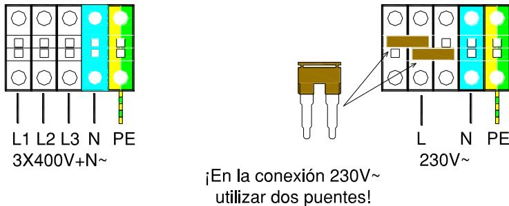
Las bornas de conexión se encuentran después de retirar el panel frontal de la caldera. Los cables de alimentación deben ser conducidos de forma segura a este punto a través de la protección pasamuros de la parte posterior de la caldera.
