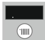
Cuando la función calefacción esté encendida el display mostrará la temperatura del agua de calefacción.
