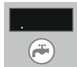
Cuando la función ACS está encendida el display mostrará la temperatura actual del agua en el acumulador interno. La caldera siempre dará prioridad al ACS sobre la calefacción hasta que la temperatura seleccionada se alcance.
