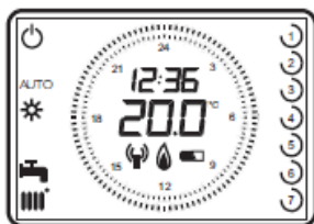
Termostato modulante programable inalámbrico
