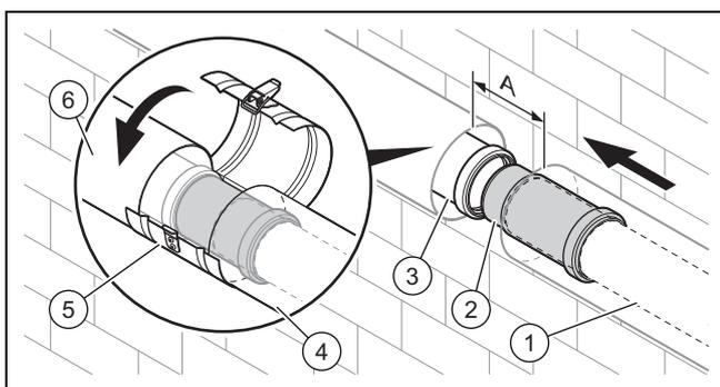
1. Inserte el dispositivo de separación (2) todo lo posible en la tubería de evacuación de gases de combustión (1).
