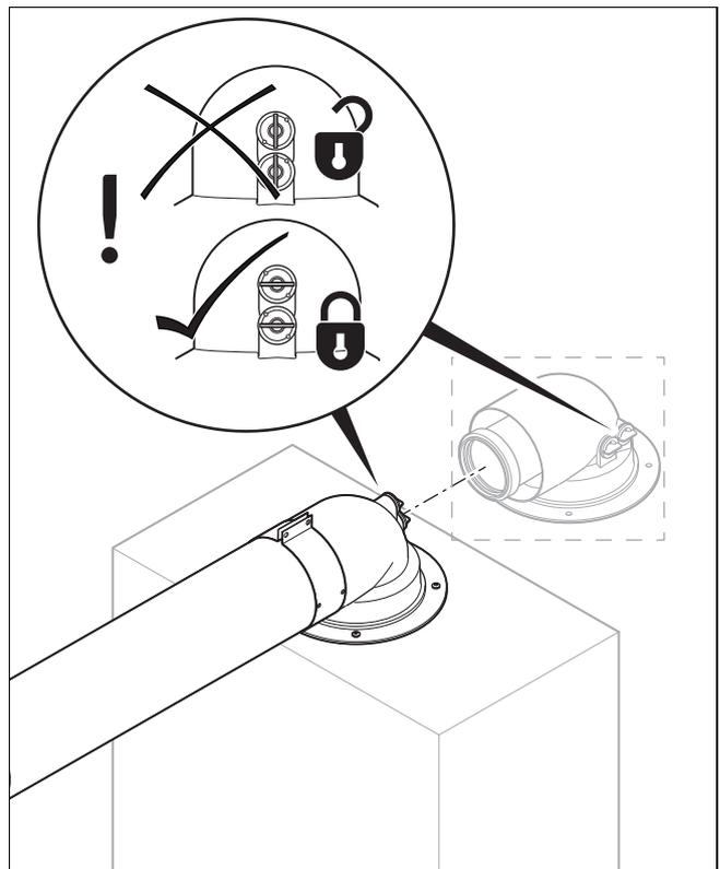
Los gases de combustión pueden salirse por aberturas de medición incompletas o no cerradas.
