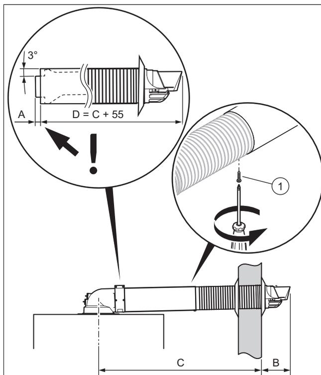
1. Tenga en cuenta las especificaciones de longitud para el montaje del conducto de aire/gases de combustión.
