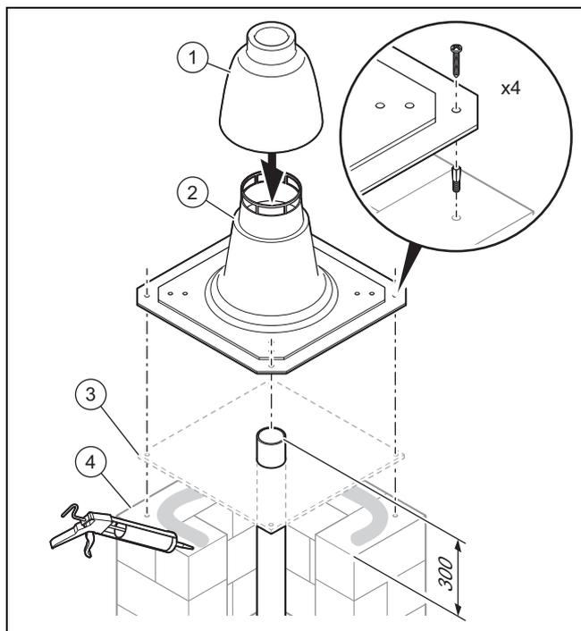
2. Retire en caso necesario el manguito de la tubería de evacuación de gases de combustión superior y acorte la tubería hasta la longitud necesaria.
