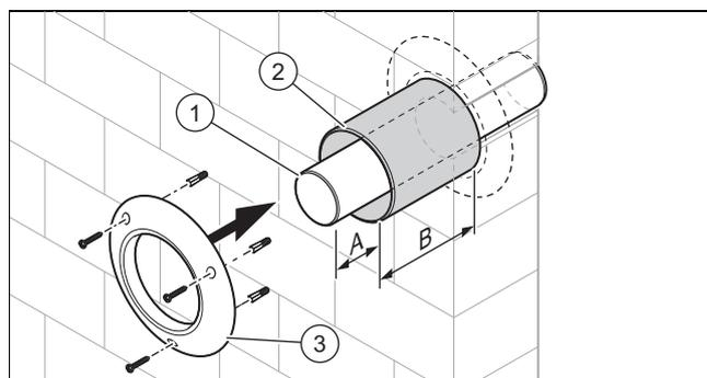
1. Acorte la tubería de evacuación de gases de combustión (1) a la longitud requerida e insértela en el codo de apoyo.
