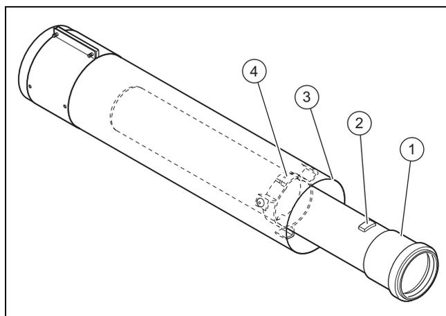
1. Gire la tubería de evacuación de gases de combustión (1) hasta que la saliente de plástico (2) salga del separador (4).
