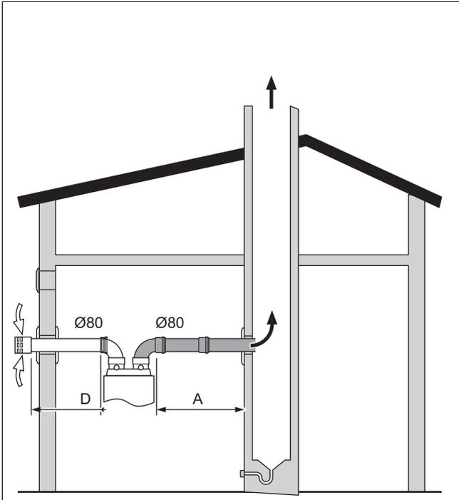
1. Inicie la construcción del sistema con el montaje de la conexión del conducto a la tubería de evacuación de gases de combustión para depresión (→ Página 30) teniendo en cuenta las correspondientes tablas de longitudes de tuberías.
