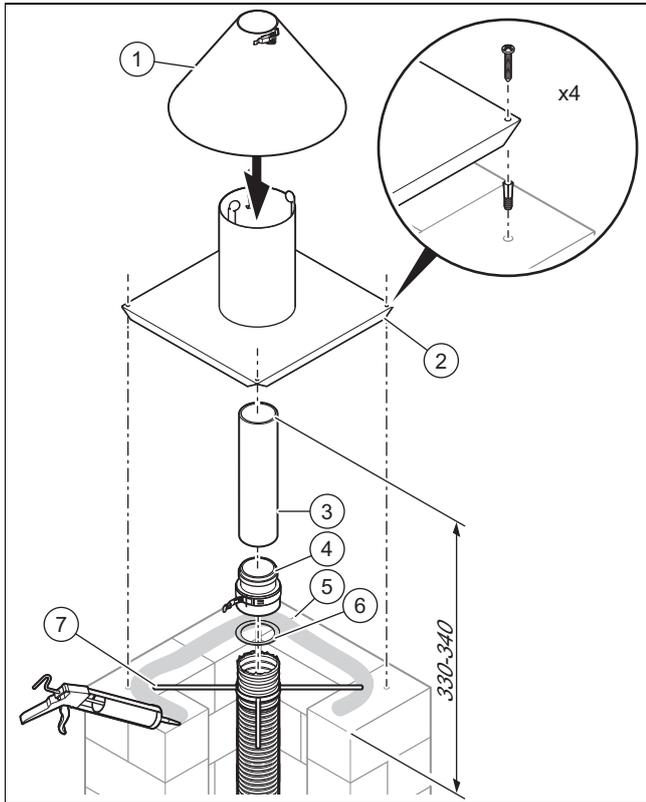
2. Inserte la cruz de montaje (7) a través de la tubería de evacuación de gases de combustión en el borde de la boca.
