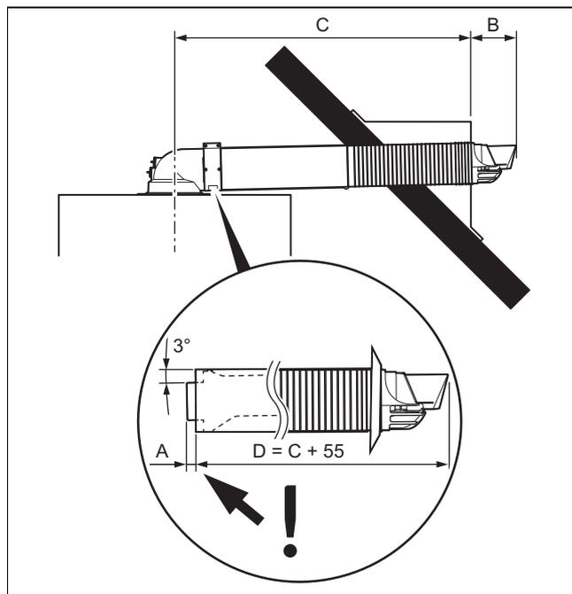
1. Tenga en cuenta las especificaciones de longitud para el montaje del conducto de aire/gases de combustión.
