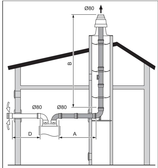
1. Inicie la construcción del sistema con el montaje de la tubería rígida de evacuación de gases de combustión (→ Página 18) teniendo en cuenta las correspondientes tablas de longitudes de tuberías.
