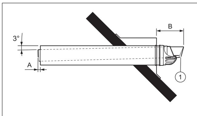
1. Tenga en cuenta las especificaciones de longitud para el montaje del conducto de aire/gases de combustión.
