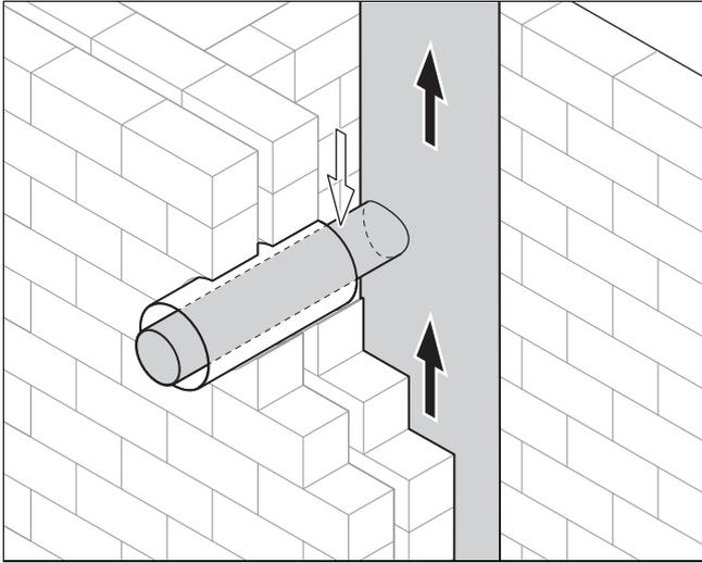
1. Establezca en el sistema de toma de aire/evacuación de gases una conexión para funcionamiento estanco teniendo en cuenta la altura de conexión del producto (incluida pieza de conexión para conducto de toma de aire/evacuación de gases y codo), tal y como se describe en las instrucciones de instalación del producto.
