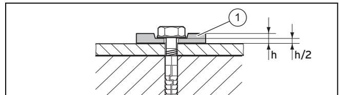
1. Monte el pie de la prolongación del conducto con 4 tornillos y arandelas flexibles(1).
