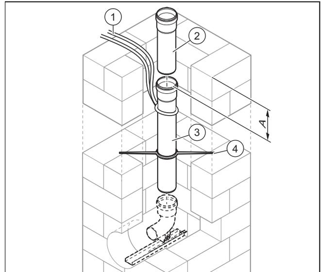
2. Con ayuda de un cable (1), baje la primera tubería de evacuación de gases de combustión (3) hasta que pueda insertarse la siguiente tubería de evacuación de gases de combustión.
