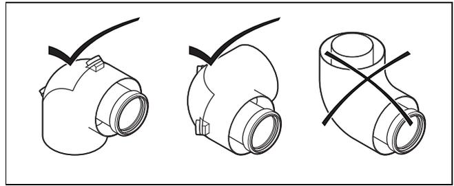
Una posición de montaje errónea provoca la salida de condensados por la tapa de la abertura de inspección y puede causar daños por corrosión.
