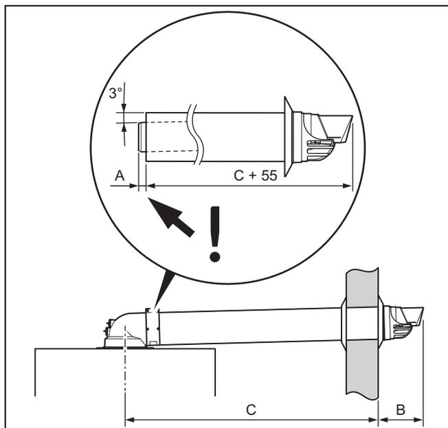
1. Tenga en cuenta las especificaciones de longitud para el montaje del conducto de aire/gases de combustión.
